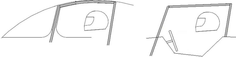
iii) Si el arco frontal se mantiene por debajo del campo visual del piloto, pero aflora más de 150mm de la estructura donde va anclado, deberá agregársele dos miembros longitudinales frontales ó un puntal oblicuo.
