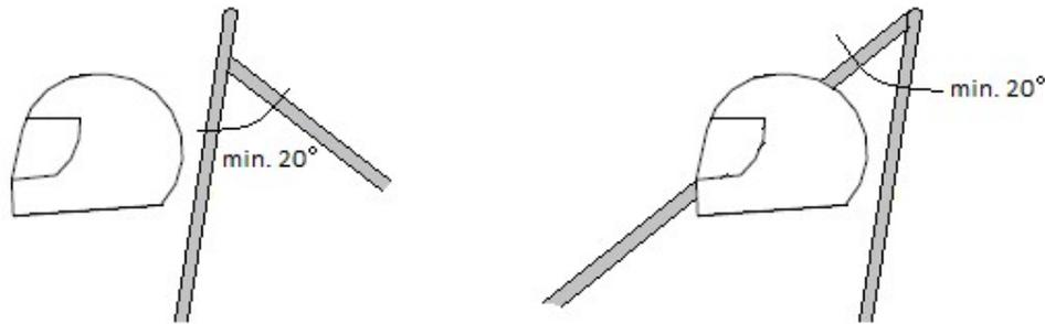
ii) Si el arco frontal aflora por encima del campo visual del piloto, deberá vincularse al arco principal mediante dos miembros longitudinales superiores.
