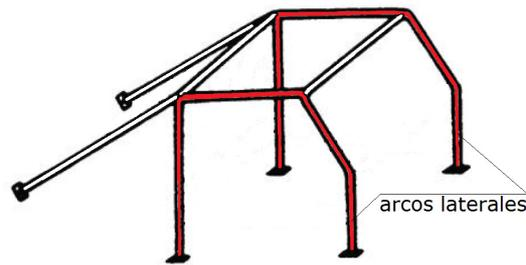
ix) **Semi-arco lateral:** similar a arco lateral pero sin el montante posterior. Se conecta a la correspondiente esquina superior de un arco principal.
