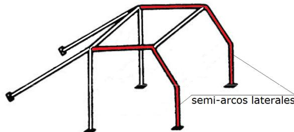
x) **Puntal o miembro longitudinal superior:** tubo recto cuasi-longitudinal que une a la altura del techo al arco principal con el arco frontal. Sus extremos se vinculan a los arcos en las esquinas de estos últimos, o a no más de 100mm de estas esquinas.
